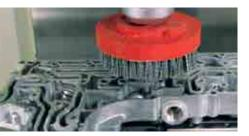
ACTION SURFACE TOOL FINISHING REMOVAL FLEXIBILITY DEBURRING, FINISHING
